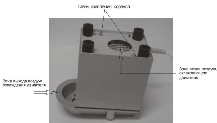
Рис.3 Вид на мельницу снизу
