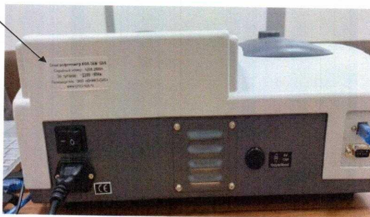
Рисунок 3 – Место нанесения серийного номера на спектрофотометры КФК-ЗКМ
