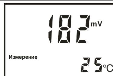
Промыть электроды дистиллированной водой, осушить их фильтровальной бумагой и погрузить в анализируемый раствор. После установления стабильных показаний считать результат измерения с дисплея.
