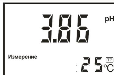
Нажимая на кнопку **РЕЖИМ**, выбрать режим «НАСТРОЙКА». При этом на дисплее начинает мигать знак «НАСТРОЙКА» и знак «pH<sub>i</sub>», а на основном и дополнительном цифровом поле дисплея сохраняются результаты текущего измерения.
