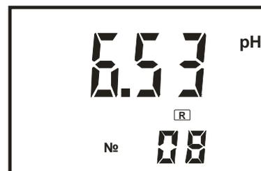
Нажатием кнопок  $\vee$  и  $\wedge$  можно выбрать любую другую ячейку блокнота от 1 до 30. На дисплее выводится значение pH (mV), сохраненное в ячейке под выбранным номером.
