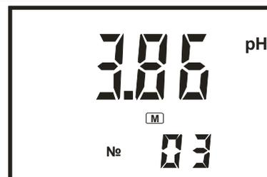
Для записи результата измерения в выбранную ячейку блокнота следует нажать кнопку «ВВОД». Прибор автоматически переходит в режим «ИЗМЕРЕНИЕ».
