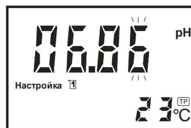
Для занесения значения pH первого градуировочного раствора в память прибора следует нажать кнопку **ВВОД**. Прибор предложит перейти к градуировке по второму раствору. На дисплее мигает значок, изображающий стаканчик с цифрой «2», приглашая поместить электродную систему и термодатчик (или термометр) во второй градуировочный раствор.
