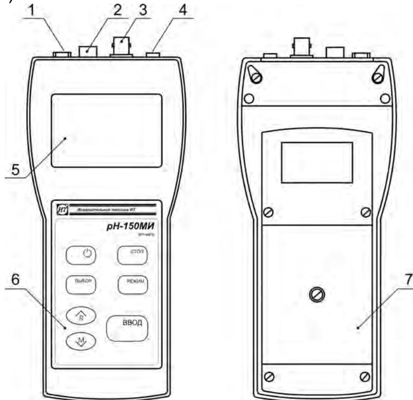
1. Гнездо «**6V...14V**» - для подключения блока сетевого питания;
