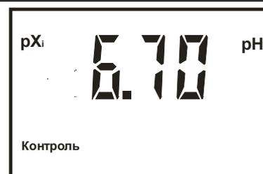
Для изменения значений координат изопотенциальной точки следует, при просмотре значения  $pX_i$ , нажать кнопку **ВВОД** и удерживать ее в течение (1-2) секунд.
