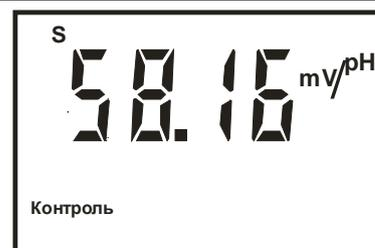
Нажать кнопку **ВВОД**. Прибор переходит в режим «**ИЗМЕРЕНИЕ**».
