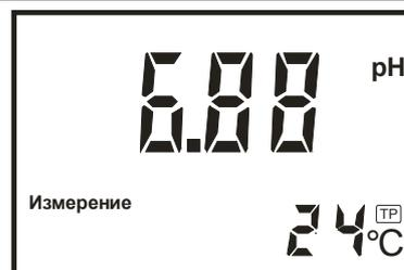
Ручной ввод температуры производится с дискретностью 1 °С.
