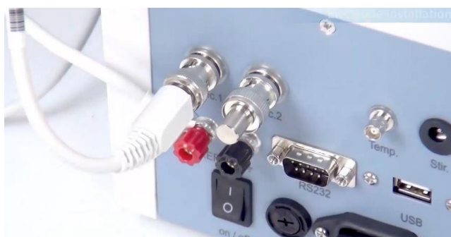
Связь с ПК через USB-интерфейс или RS-232
