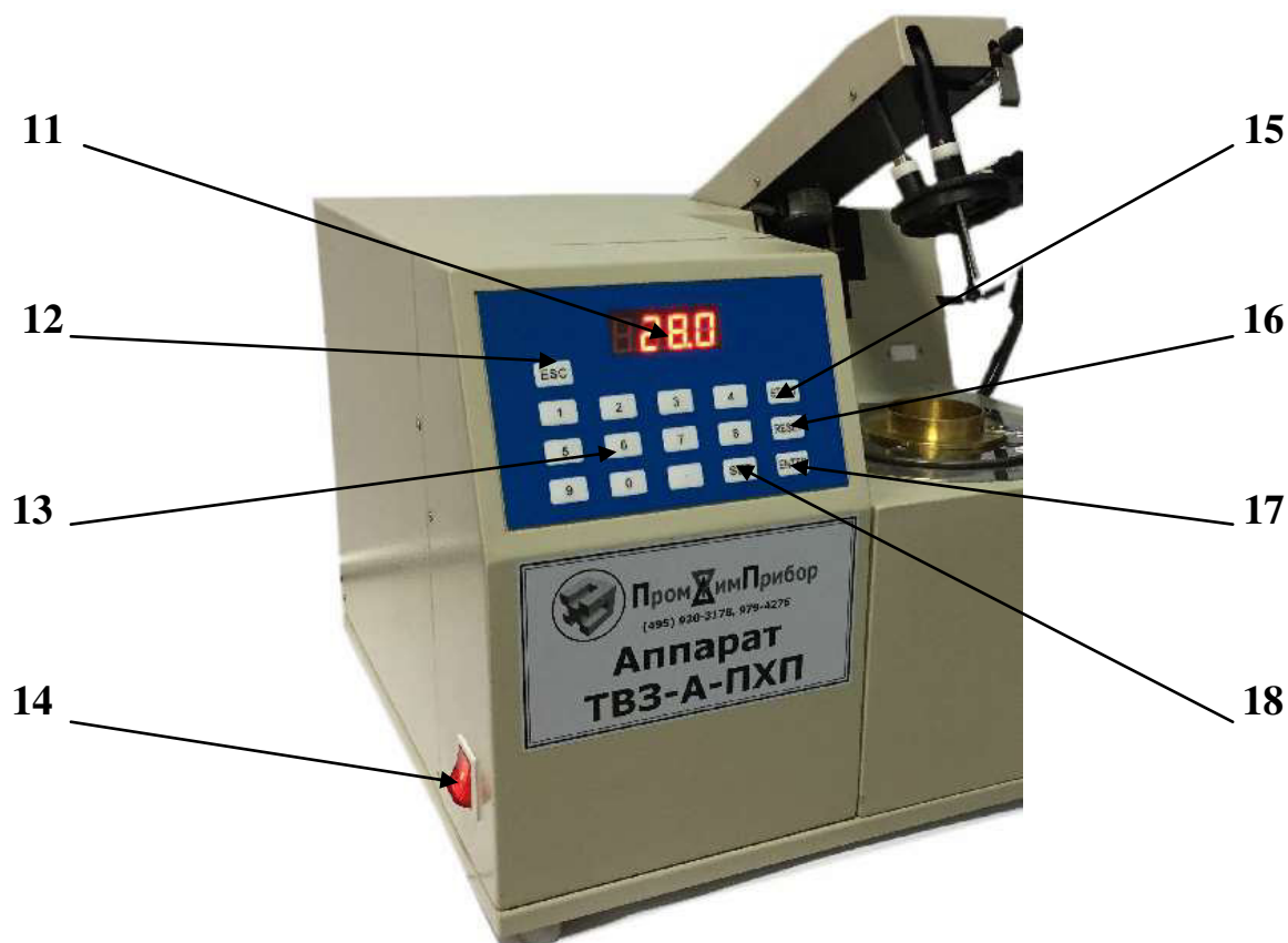
Рис. 4. Устройство аппарата ТВЗ-А-ПХП Блок управления с электронным дисплеем
