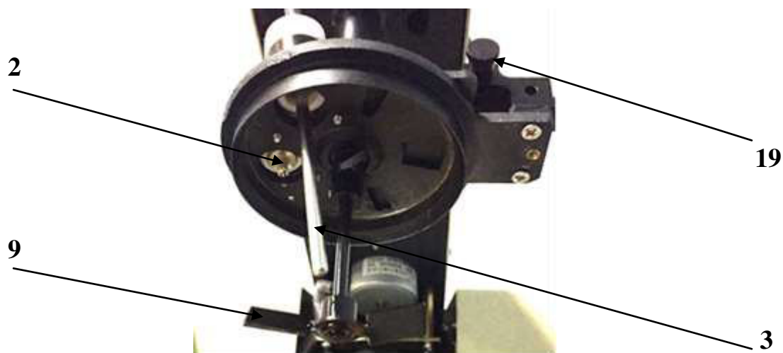
Рис. 5. Вид на механизм крышки тигля снизу
