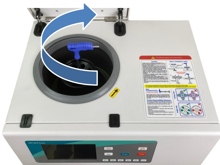
Рисунок 5 – Фиксация ротора и крышки
