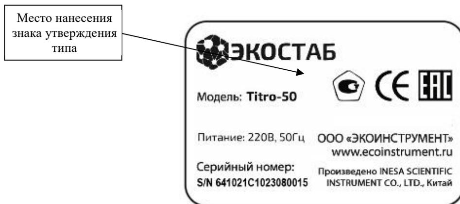
Рисунок 2 – Маркировочная табличка титраторов ЭКОСТАБ Titro
