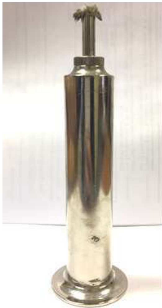
Рис 5, 6 Внешний вид топливного резервуара ЛВП-М-ПХП
