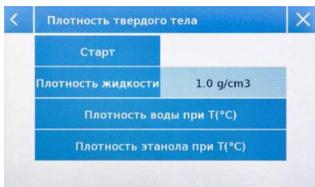
**Плотность твердого тела:** при выборе этого параметра вам потребуется ввести значение плотности жидкости ( $\text{г}/\text{см}^3$ ), которое будет использоваться для определения плотности твердого вещества. При использовании дистиллированной воды или этанола введите только значение температуры. Значение плотности при выбранной температуре будет рассчитано автоматически. Затем нажмите кнопку «Старт», чтобы продолжить измерение.
