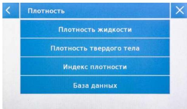
**Плотность жидкости:** при выборе этого параметра вам потребуется ввести значение плотности твердого вещества грузила ( $\text{г}/\text{см}^3$ ), которое будет использоваться для определения плотности жидкости. Затем нажмите кнопку «Старт», чтобы продолжить измерение.
