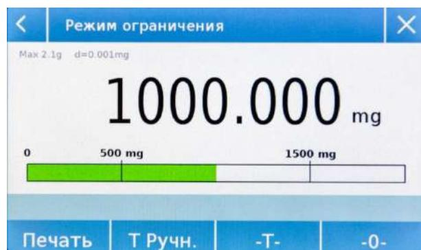
Полоса проверки веса становится желтой, когда загруженный вес ниже минимального порога, и зеленым, когда вес находится в пределах установленного диапазона (со звуковым сигналом при активации), и красным, когда вес превышает установленный верхний порог.
