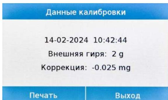
**Данные калибровки:** на экране данных калибровки можно проверить дату последней калибровки, режим, в котором она выполнялась, используемое значение веса и поправку, сделанную по сравнению с предыдущей калибровкой. Прикоснувшись к клавише «Печать», вы можете распечатать отображаемые данные.
