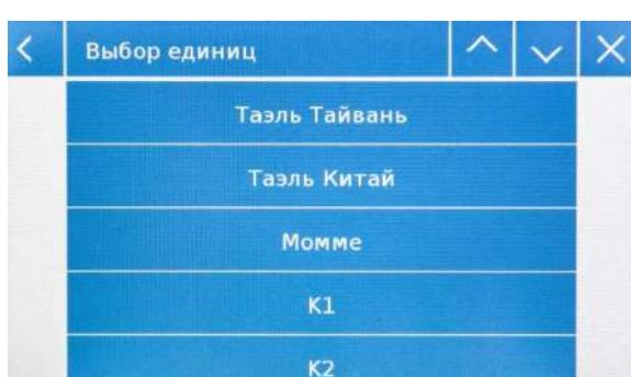
**Примечание.** Выбор единицы измерения также может быть сделан непосредственно с главного экрана взвешивания; коснувшись символа отображаемой единицы измерения, вы получите прямой доступ к списку доступных единиц измерения.
