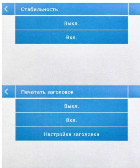
**Стабильность:** проверка стабильности перед передачей данных. Перед печатью значения веса можно выбрать, следует ли включить или отключить контроль стабильности.
