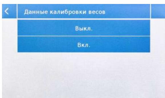
**Данные калибровки весов:** позволяет включать или отключать печать данных калибровки весов.
