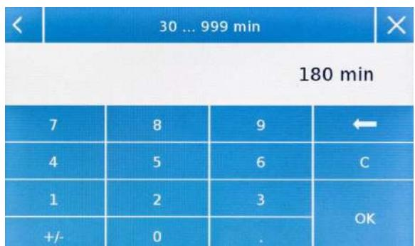
Чтобы изменить диапазон автокалибровки, коснитесь кнопки «Интервал» и установите желаемый диапазон от 30 до 999 минут.
