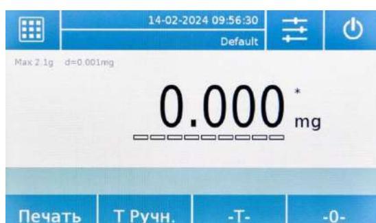
На экране взвешивания в области, отображающей вес, отображается значение веса, помещенного на платформу весов.
