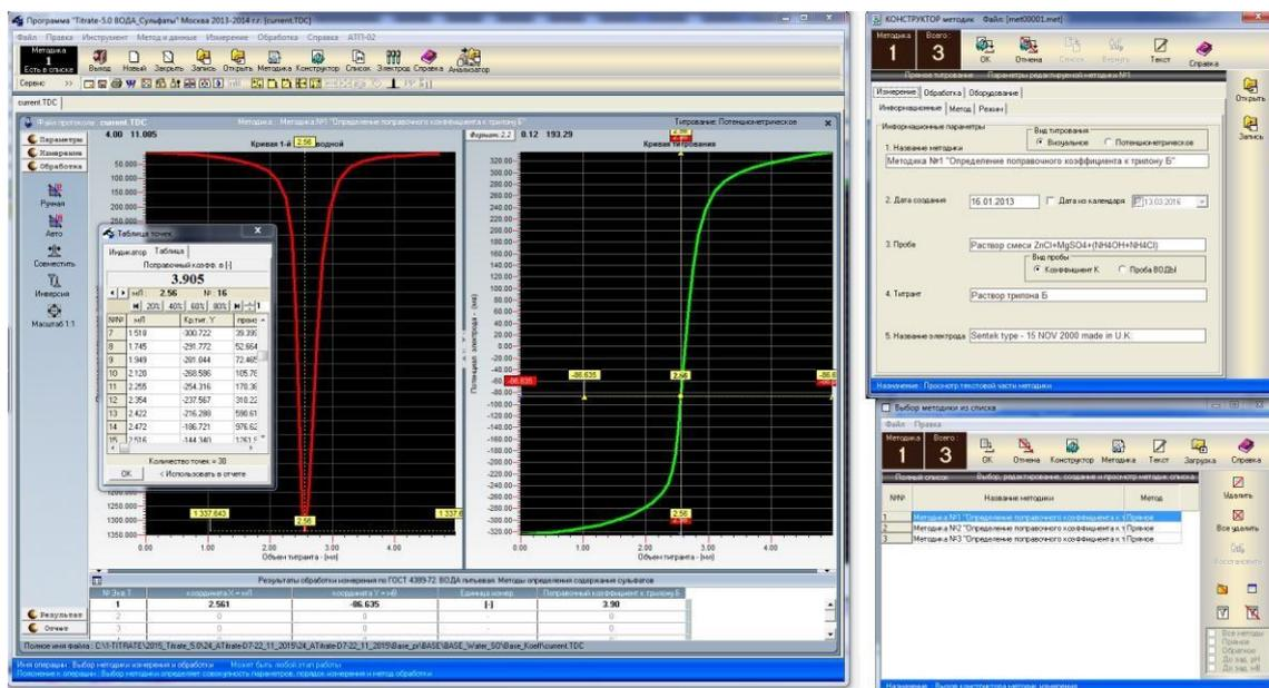
Программа "Titrate ВОДА\_Сульфаты" предназначена для измерений, обеспечивающих определение содержания сульфатов в питьевой ВОДЕ согласно ГОСТ 4389-72. Метод измерения основан на осаждении ионов  $SO_4^{2-}$  хлористым барием. Осадок сернокислого бария растворяют в титрованном растворе трилона Б, избыток которого определяют титрованием раствором хлористого магния. Количество трилона Б, израсходованное на растворение сернокислого бария, эквивалентно количеству сульфат ионов во взятом объеме воды.
