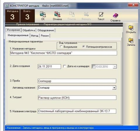
Программа "Titrate ЛЕСХИМ-К" предназначена для измерений, обеспечивающих определение К - кислотного ЧИСЛА, показывающее количество миллиграммов гидроксида калия КОН, необходимое для нейтрализации свободных кислот, содержащихся в 1 г
