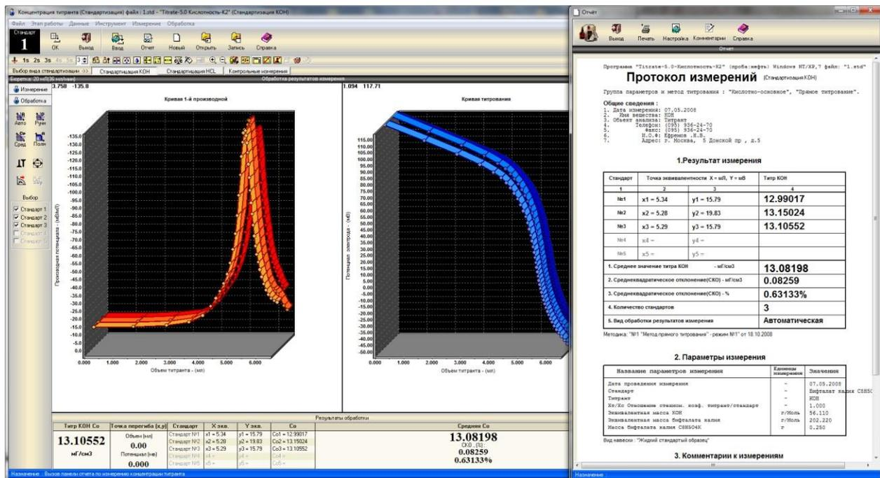
Программа "Titrate Кислотность-K2" предназначена для измерений, обеспечивающих определение кислотного числа сильных кислот К2 в нефтепродуктах и смазочных материалах согласно ГОСТ 11362-96 (ИСО 6619-88).
