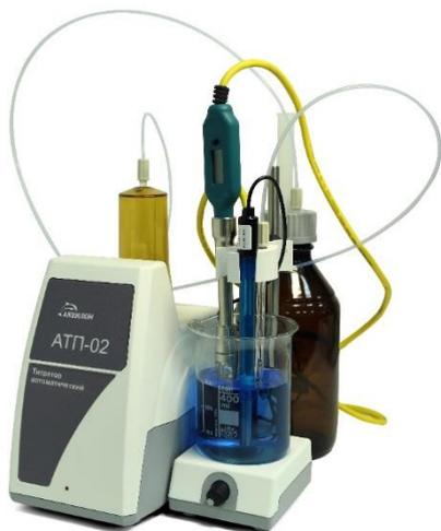
**АТП-02** – автоматический высокоточный потенциометрический титратор. Прибор отвечает всем требованиям, предъявляемым к данному классу оборудования: непрерывная и дискретная подача титранта (диапазон от 0,1 до 36 мл/мин – при объёме дозирующего устройства 20 мл; и от 0,25 до 90 мл/мин – при объёме дозирующего устройства 50 мл), автоматическое изменение скорости подачи по мере приближения к точке эквивалентности или заданной точке и т.д.
