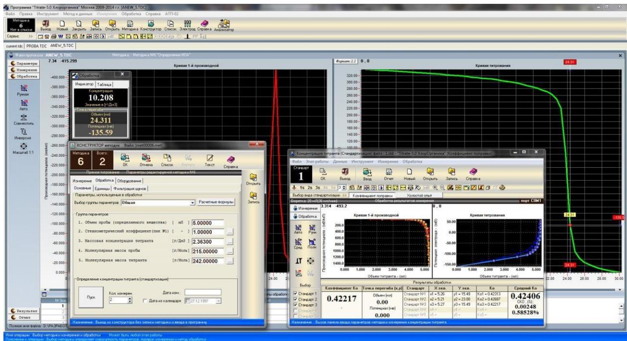
Программный комплекс "Titrate ХлорОрганика" содержит весь инструментарий программного комплекса "Titrate Deluxe". Особенностью настоящего программного продукта является жесткая настройка программы на выполнение требований по проведению измерений по ГОСТ Р 52247-2004, ASTM Д 4929-99.
