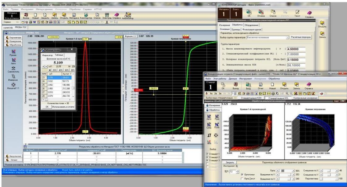
Программный комплекс "Titrate Щелочь-Щ2" предназначен для измерений, обеспечивающих определение общего щелочного числа нефтепродуктах по ГОСТ 11362-96, ИСО 6619-88.
