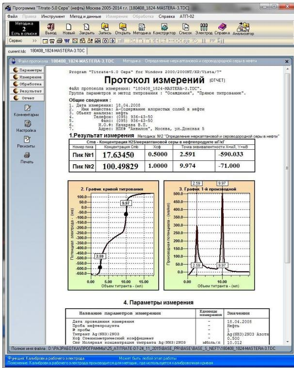
Программный комплекс "Titrate Sера" предназначен для измерений, обеспечивающих определение концентраций сероводородной и меркаптановой серы в нефти и нефтепродуктах по ГОСТ 17823-71, СТСЭВ 756-77, USA ASTM D3227-00, IP 399.
