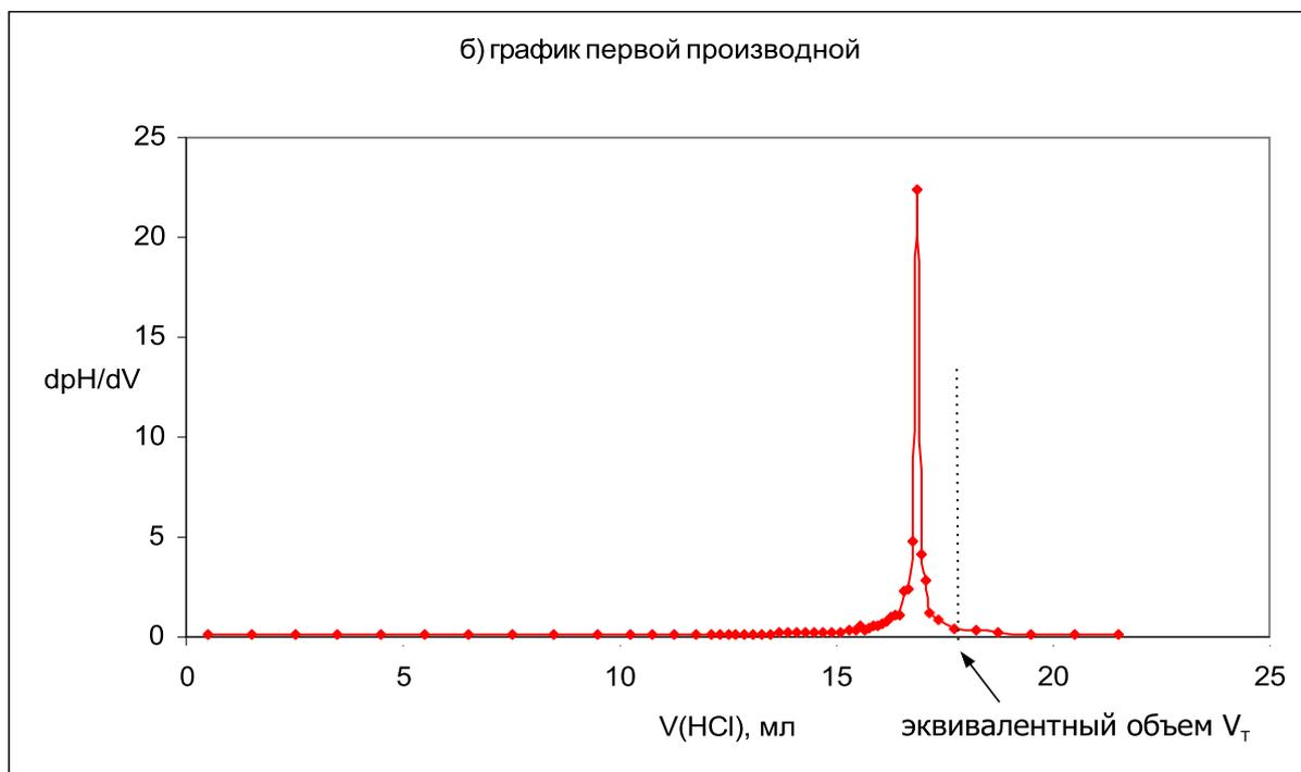
Рис.2. Кривая титрования (а) и график первой производной кривой титрования (б)
