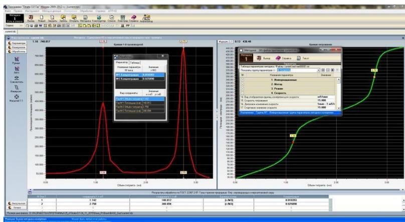
Программный комплекс "Titrate Газ" содержит весь инструментарий программного комплекса "Titrate Deluxe". Порядок работы и список возможностей данного программного продукта аналогичен "Titrate Deluxe". Особенностью настоящего программного продукта является жесткая настройка ПП на выполнение требований по проведению измерений по ГОСТ 22387.2-97.
