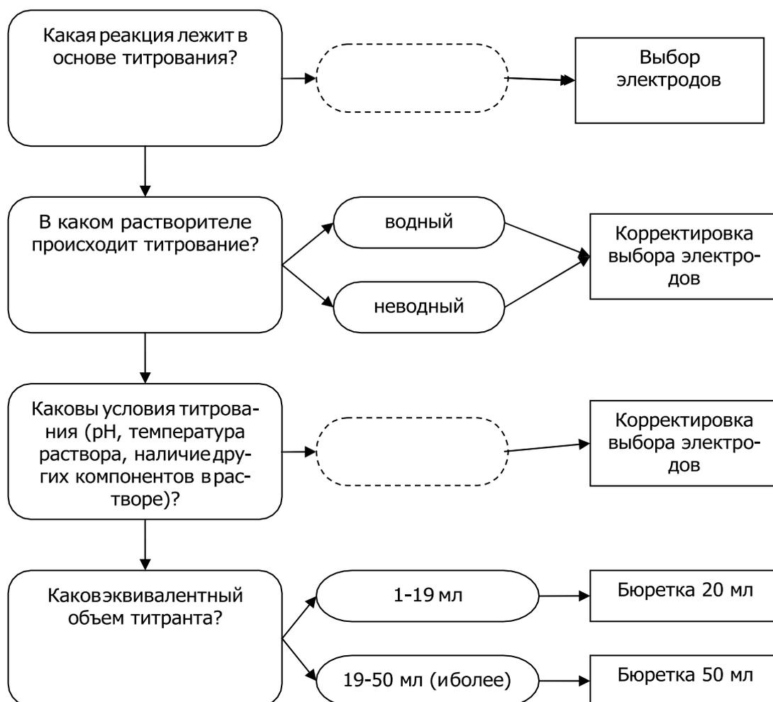
Рис.4. Схема выбора электродов и объема бюретки
