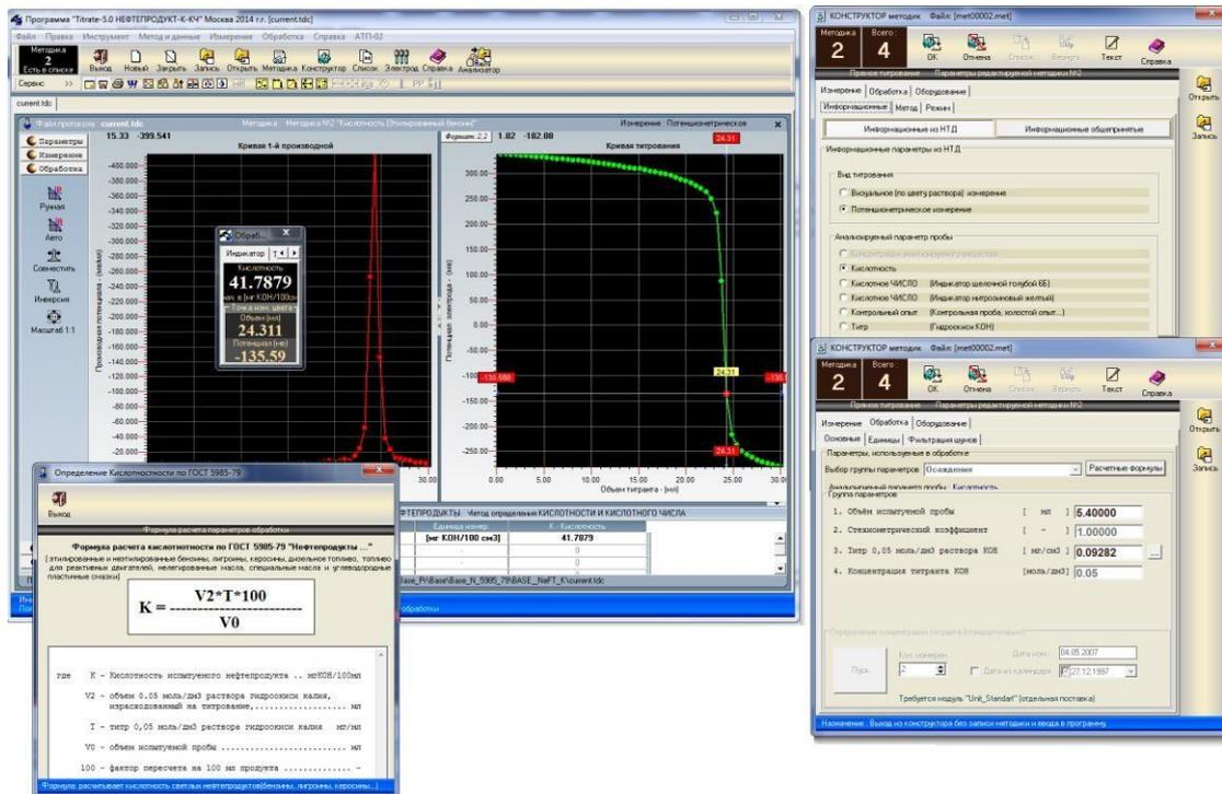
Программа "Titrate НЕФТЕПРОДУКТЫ-К-КЧ" предназначена для измерений, обеспечивающих определение К-кислотности, К1- кислотного ЧИСЛА по ГОСТ 5985-79 светлых нефтепродуктов. Программа реализует титрование кислых соединений испытуемого продукта спиртовым раствором гидроксида калия в присутствии цветного индикатора и определении для светлых нефтепродуктов кислотности, выраженной в мг КОН/100 см<sup>3</sup>, для масел и смазок - кислотного числа, выраженного в мг КОН/г
