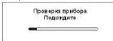
Если при тестировании неисправности не обнаружено, газоанализатор переходит в режим измерения. Индикатор имеет вид:
