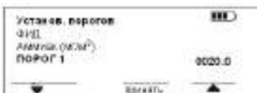
Используя кнопки **▲** и **▼** установите новое значение ПОРОГ 1 и нажмите кнопку **принять**. Газоанализатор перейдет к установке нового значения значения ПОРОГ 2:
