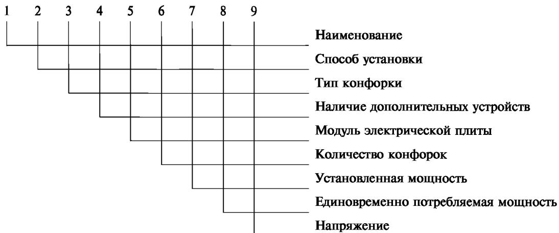
Обозначение электроплит должно состоять из букв и цифр, означающих: первые четыре обозначения — буквенные, далее цифровые — ширина электроплиты(дм), количество конфорок, установленная мощность и (через косую черту) единовременно потребляемая мощность, номинальное напряжение, обозначение настоящего стандарта.
