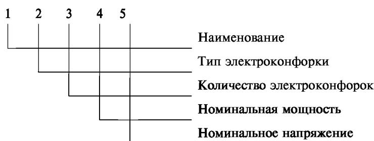
Обозначение электроплиток должно состоять из букв и цифр, означающих: первые три — обозначения буквенные, далее цифровые — номинальная мощность и номинальное напряжение.
