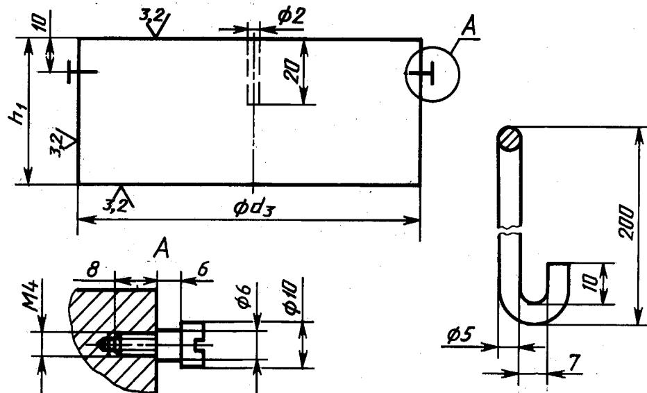
Материал блока — алюминий 92—96 % с удельной теплоемкостью 896 Дж/(кг·К) при 20 °C.
