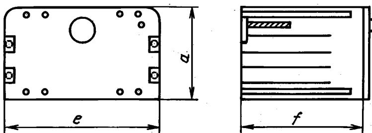
$a$  — высота жарочного электрошкафа, измеренная между внутренними верхней и нижней поверхностями;
