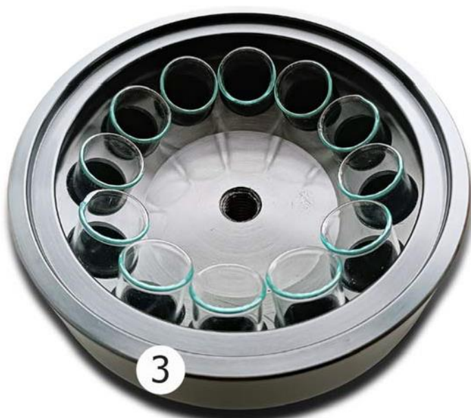
Установлены конические пробирки 10 мл. Длина 109 мм. Изготовлены из стекла ХС1
