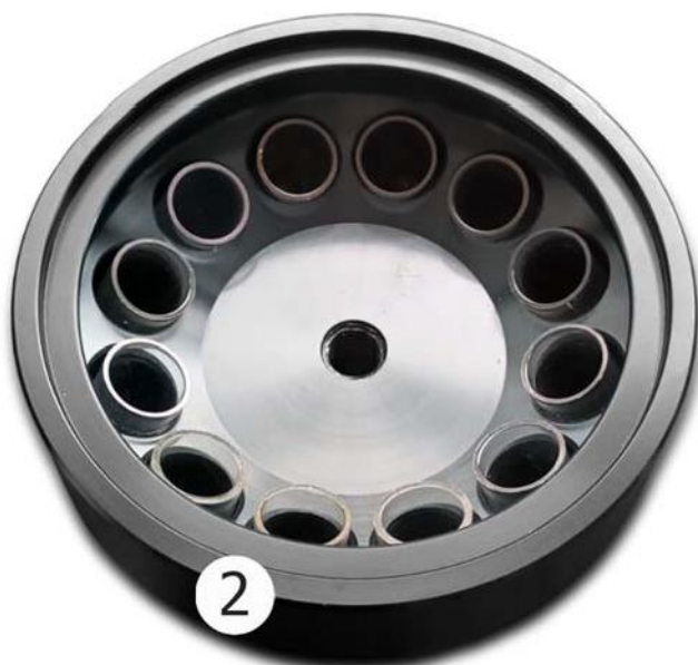
Установлены круглодонные пробирки 10 (12) мл. Длина пробирок 100 мм.
