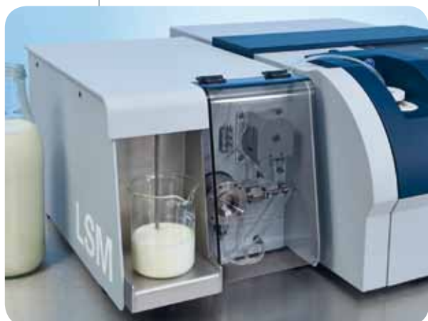
Рис.2: Анализ молока и жидких молочных продуктов с использованием LSM (Liquid Sampling Module)
